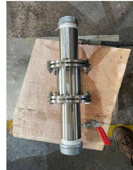
**Cavitador Hidrodinámico Mixto**
